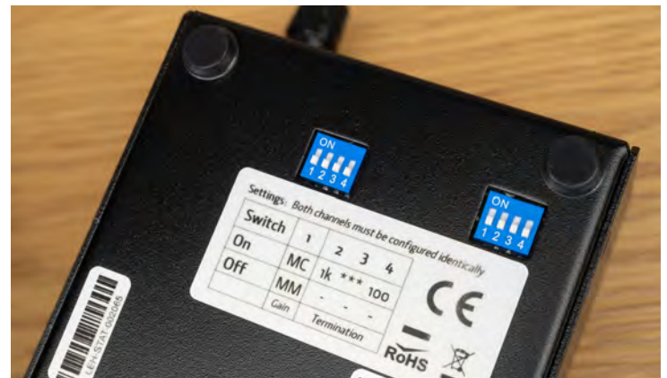
Mit den Dipschaltern auf der Unterseite lässt sich der Phono-Vorverstärker genau auf den genutzten Tonabnehmer einstellen.
